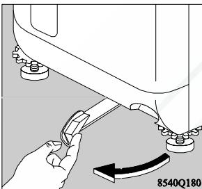
Для перестановки стиральной машины следует установить ее на ролики, переведя сперва налево рычаг, расположенный внизу аппарата. Когда машина будет установлена в нужное место, вернуть рычаг в начальное положение.
