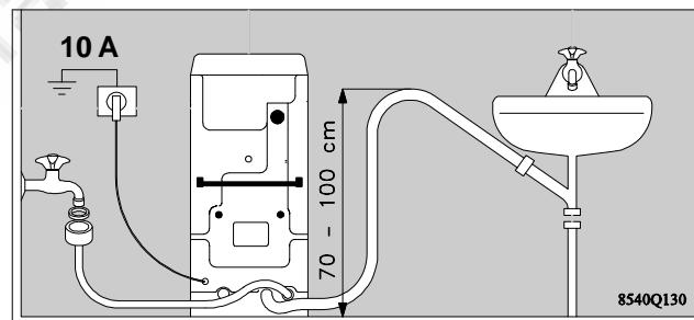
Прибор должен быть установлен на ровной и твердой поверхности. Убедитесь в том, что прибор не соприкасается с стеной или другой мебелью. Кран, место слива и электрическая розетка должны быть расположены вблизи прибора.
