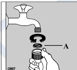
Навинтите соединительное кольцо шланга нарезьбовой конец водопроводного крана (20 x 27), не забудьте установить прокладку А (поставляется вместе с прибором). Подводной шланг нельзя удлинять. Если шланг слишком короткий, его нужно заменить на более длинный шланг высокого давления. Подводной шланг
