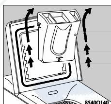
Нажмите на крепления, расположенные с двух сторон дозатора и вытяните его вверх
