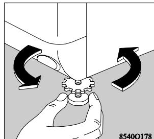
Аппарат выравнивается с помощью ввинчивания или вывинчивания винтовых установочных ножек.
